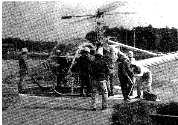
▲ヘリコプターに農薬をつみこんでいるところ 去る6月10日、ツマグロ、ウンカ類の害虫に対する空中散布が行われました。 この作業は3機のヘリコプターにより午前5時から9時30分頃まで行われ、441.3ヘクタールの水田に13,240キロのマラバッサDL粉剤が散布されました。
