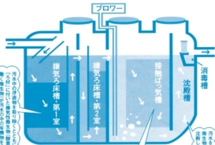
フローワーから送り込まれる空気が十分にふる状態で曝気材に付いて増殖した好気性の微生物が大いに働き、汚れを分解します。
