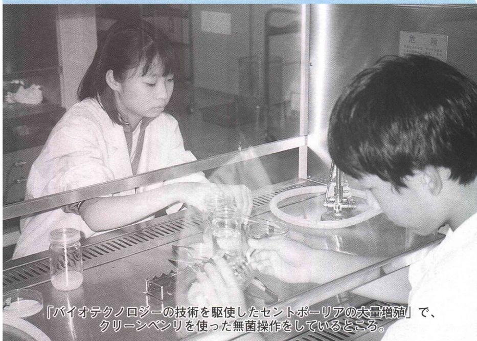
「バイオテクノロジーの技術を駆使したセントポーリアの大量増殖」で、クリーンベンチを使った無菌操作をしているところ。
